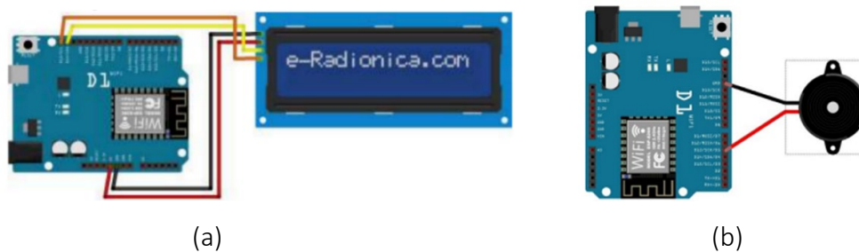
Gambar 3. Diagram Skematis (a) WeMos D1 dengan LCD, dan (b) WeMos D1 dengan Sensor Buzzer (Damayanti, 2023)
